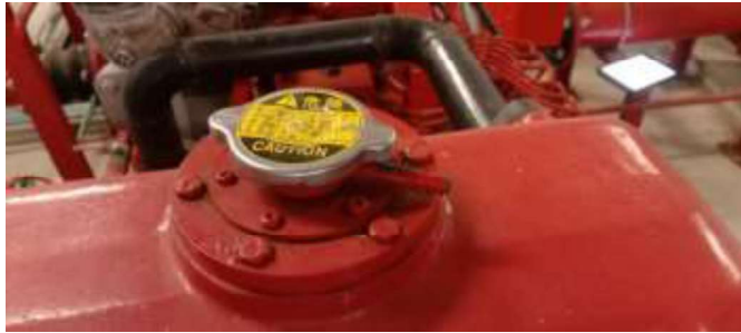
รูปที่ 14 ตรวจสอบเช็คฝาปิดหม้อน้ำ
