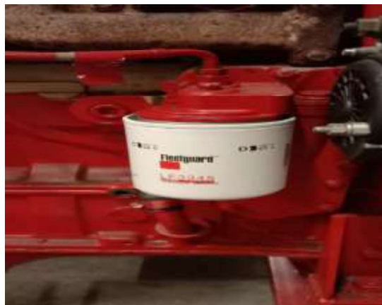
รูปที่ 8 ตรวจเช็คตัวกรองน้ำมันกรองน้ำมันโซล่า
